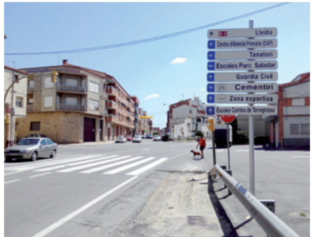
Pas de vianants que no continua fins a la vorera de l'altre costat
