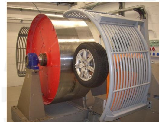
Laboratorio de Resistencia a la Rodadura
