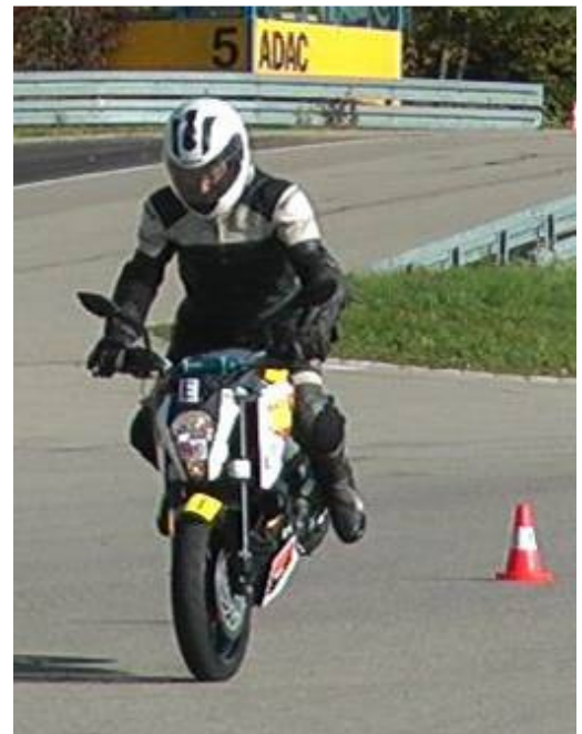
Fig. 1: Un centro de gravedad alto, una distancia entre ejes corta y poco peso incrementan la tendencia al vuelco: Las superbikes generalmente son más sensibles que los scooters.
