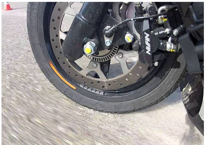
Fig. 2: La suciedad en la carretera se simula con una superficie cubierta de arena de cuarzo. Sin ABS los pilotos generalmente se quedan por debajo de las deceleraciones máximas alcanzables para evitar el bloqueo de la rueda delantera. El ABS ofrece la posibilidad de lograr el máximo.
