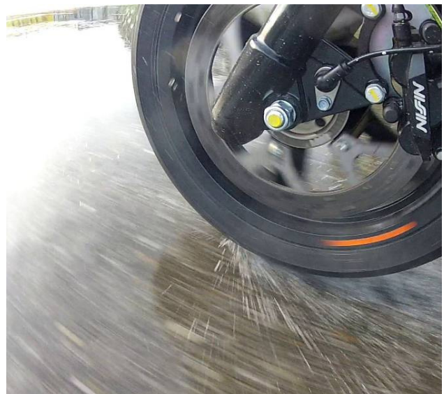
Fig. 3: Sobre suelo mojado las diferencias entre frenos convencionales y sistemas con ABS son mayores.
