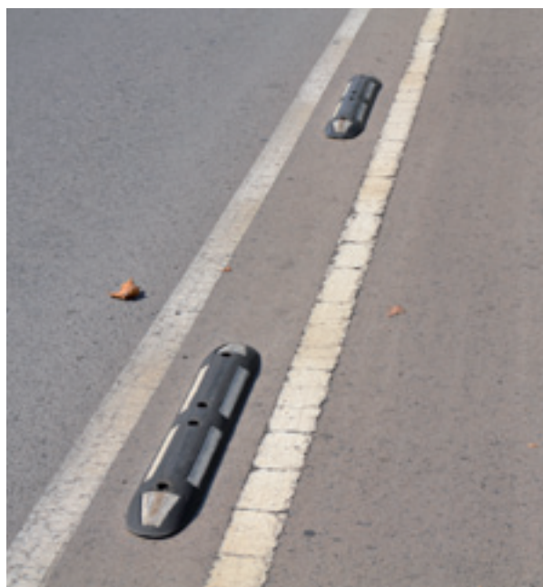
"Ulls de gat" en els elements protectors del carril bici
