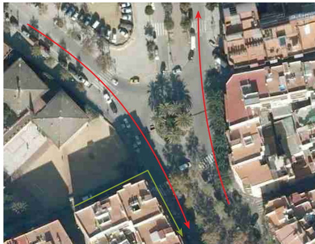
Moviments tangencials a la rotonda Urbana (vermell) i sortida perillosa des del carrer d'Àvila (verd).
