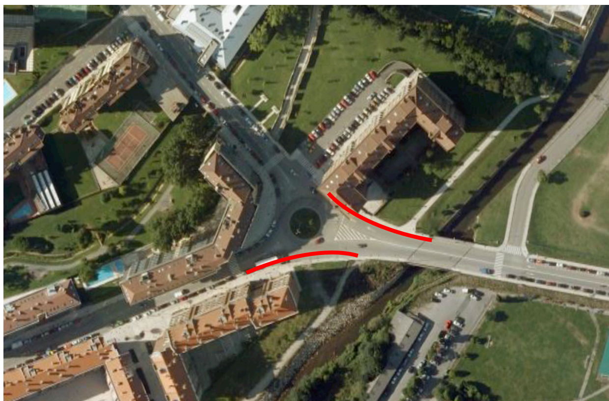
Movimientos tangenciales a la isleta central que permiten altas velocidades (Glorieta 2)
