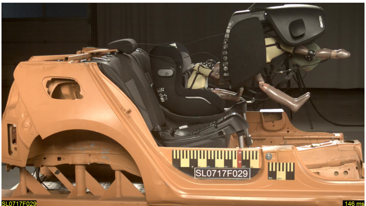
Figura 1: Recaro Optia & Smart Click Base al test d'impacte frontal
