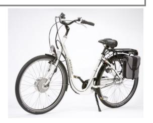
**Características:** Bicicleta confortable para la ciudad, relativamente pesada, con cuadro bajo, ayuda para el arranque y freno de contrapedal. En su mayoría buen equipamiento y acabado, asistencia con suficiente potencia y mando sensible. Ubicación poco práctica de la batería en un bolso lateral izquierdo, accionamiento ruidoso.
