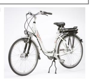
**Características:** Bicicleta confortable para la ciudad, sencilla, robusta y cómoda, pero relativamente pesada, con equipamiento y acabado adecuado, con ayuda para el arranque y freno de contrapedal. Asistencia con suficiente fuerza. Operación algo complicada del control del accionamiento, al accionar la palanca del freno el accionamiento sigue funcionando.
