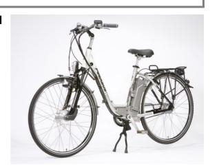
**Características:** Bicicleta confortable para la ciudad, sencilla y robusta, relativamente ligera, buen equipamiento y acabado, con ayuda para el arranque y freno de contrapedal. Potente asistencia. En situaciones extremas ligeras debilidades en la controlabilidad. En el rango superior de carga, el accionamiento muestra ligeras debilidades. Unidades de operación del accionamiento buenas, fáciles de comprender.
