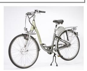
**Características:** Bicicleta confortable para la ciudad, sencilla y robusta con equipamiento y acabado adecuado para el precio, motor compacto en la rueda delantera, batería ligera, integrada de forma elegante, con ayuda para el arranque y freno de contrapedal. Debilidades en los frenos de mano.
