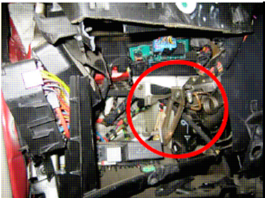
Piezas con cantos extremadamente cortantes en la zona de golpe de la rodilla
