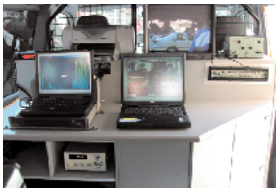
Equip de captació que recull la informació en temps real i l'emmagatzema en bases de dades referenciades cartogràficament.
