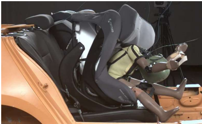
Figura 1: En el impacto frontal, el capazo del Concord Ultimax i-Size se rompió
