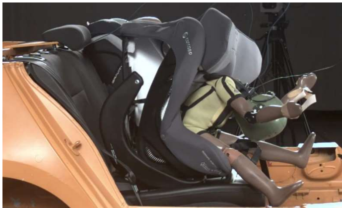
Figura 1: En l'impacte frontal, el cabàs del Concord Ultimax i-Size es va trencar
