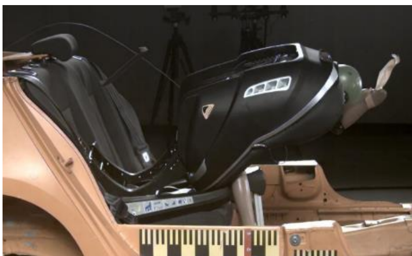
Foto 1: Foppapedretti Uniko i-Size en el ensayo de impacto frontal con un dummy Q3
