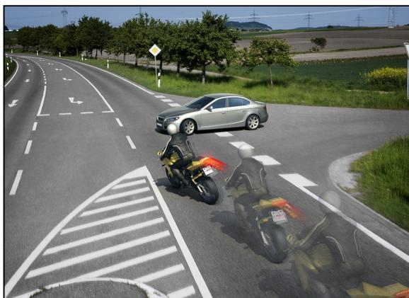
El ABS permite que el conductor siga teniendo el control sobre la trayectoria del vehículo, con la consiguiente posibilidad de poder esquivar el obstáculo causante de la situación de riesgo.
