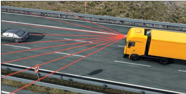
Área monitorizada por el sistema de alerta de velocidad
