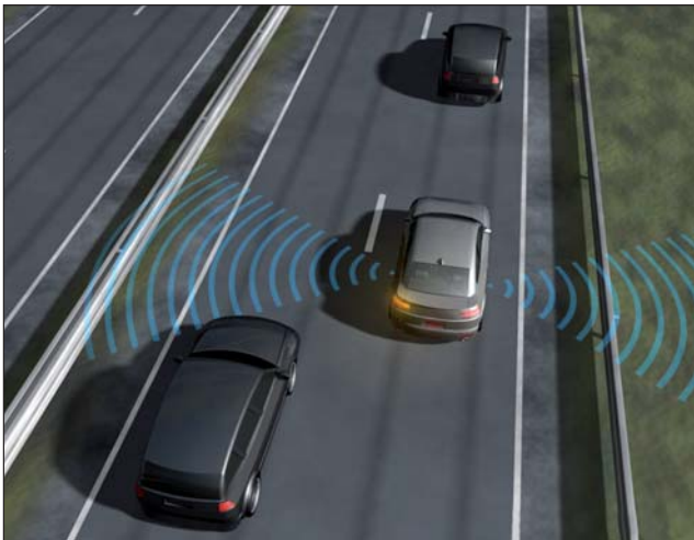
Áreas cubiertas por el sistema de monitorización de ángulos muertos.
