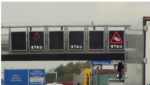
Algunos LEDs funcionando por impulsos pueden no ser reconocidos por la cámaras de abordado. Las imágenes en la parte superior e inferior muestran cómo “desaparecen” señales completas.
