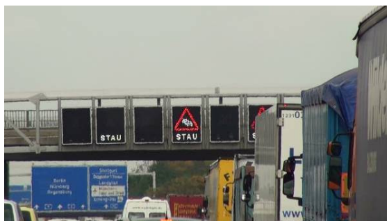
Algunos LEDs funcionando por impulsos pueden no ser reconocidos por la cámaras de abordado. Las imágenes en la parte superior e inferior muestran cómo “desaparecen” señales completas.
