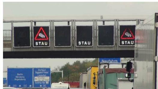
Algunos LEDs funcionando por impulsos pueden no ser reconocidos por la cámaras de abordado. Las imágenes en la parte superior e inferior muestran cómo “desaparecen” señales completas.
