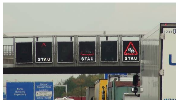
Algunos LEDs funcionando por impulsos pueden no ser reconocidos por la cámaras de abordado. Las imágenes en la parte superior e inferior muestran cómo “desaparecen” señales completas.
